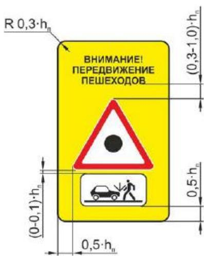
Рисунок В.11 - Пример компоновки изображений знаков стандартной формы, расположенных на фоновом щите желтого цвета
