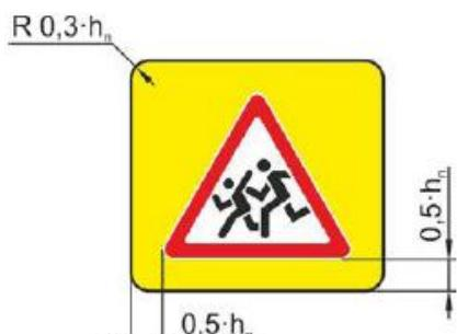
Рисунок В.8 - Пример компоновки изображения знака в форме треугольника, расположенного на фоновом щите желтого цвета
