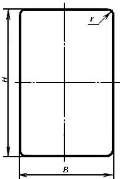
Рисунок Д.7 - Размеры прямоугольных знаков вертикального формата
