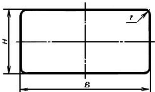
Рисунок Д.8 - Размеры прямоугольных знаков горизонтального формата
