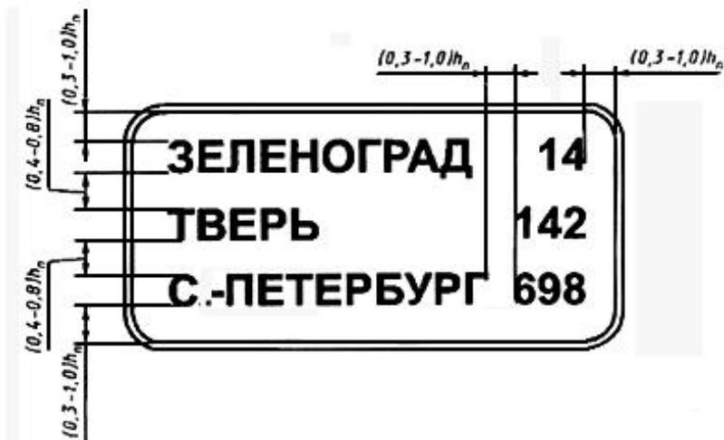
Рисунок Г.5 - Пример компоновки знака индивидуального проектирования 6.12
